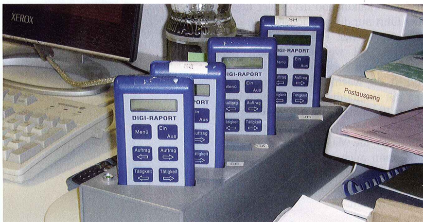
Zentrale Anlaufstation am Morgen im Büro der Firma Holz.exe ist die Ladestation der Digi-Raport Zeiterfassungsgeräte. Über Nacht wurden alle Daten mit der EDV synchronisiert
